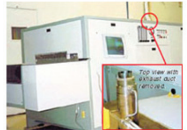
오븐의 뜨거운 가스를 스테인리스재질 증폭기로 흡입하여 배출하는 모습 (모델 6032)
